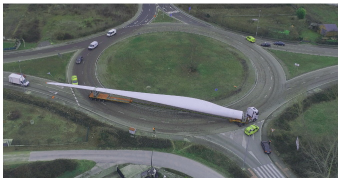
Première pale d'éolienne thermoplastique avec la résine Elium® avec l'aimable autorisation de LM Wind Power
