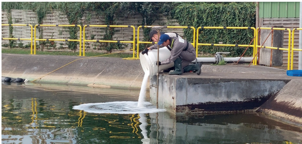
Déversement de GPI dans la zone d'expérimentation du Cedre pour étudier leur comportement et tester des techniques de récupération ©Cedre
