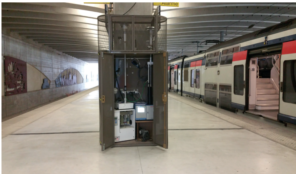
Exemple d'un dispositif de surveillance de la qualité de l'air mis en place par la SNCF.
